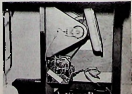
Afb. 9. Het draaiende luidsprekersysteem van Yamaha.
